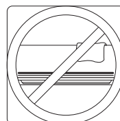
Assurer que rien ne bloque toutes les entrées et sorties d'air
